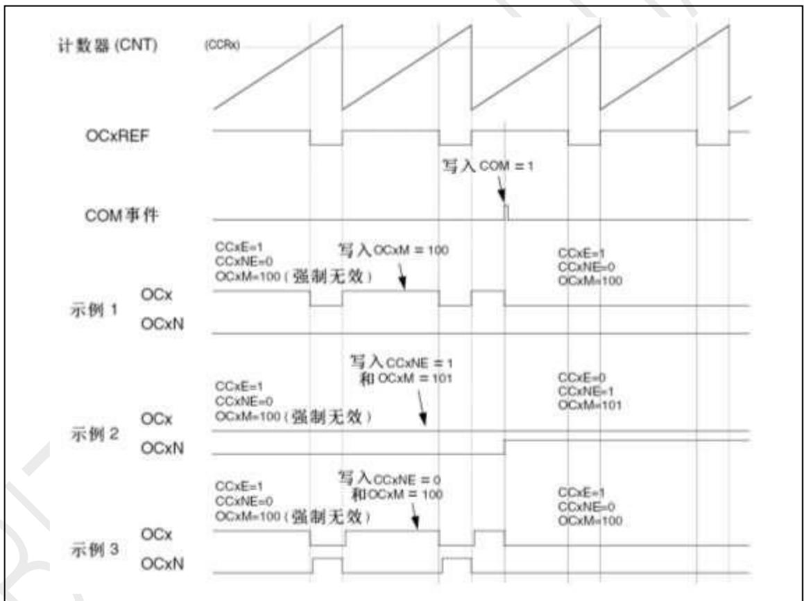
图 12-40 产生六步 PWM，使用 COM 的例子(OSSR=1)
