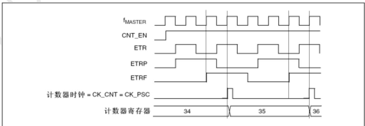
图 13-25 外部时钟模式 2 下的控制电路
