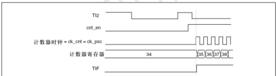
图 12-47 触发器模式下的控制电路
