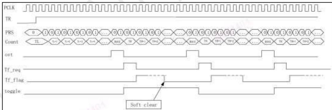
图 15-5 32 位模式 2 时序图(PCLK 二分频, max=0xFFFF FFFF)
