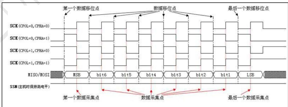
图 24-1 主机方式数据/时钟时序图
