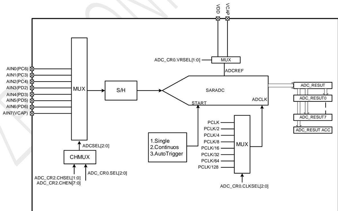
图 28-1 ADC 示意框图
