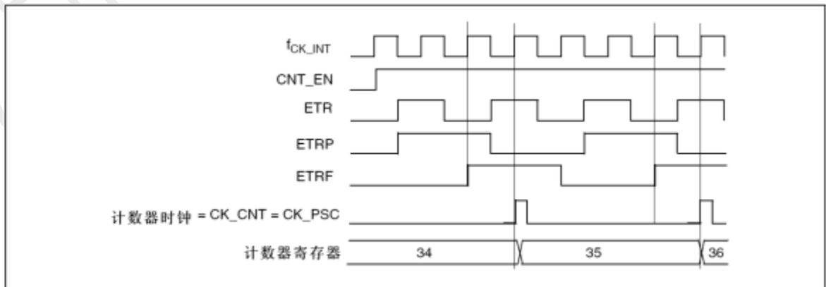
图 12-26 外部时钟模式 2 下的控制电路
