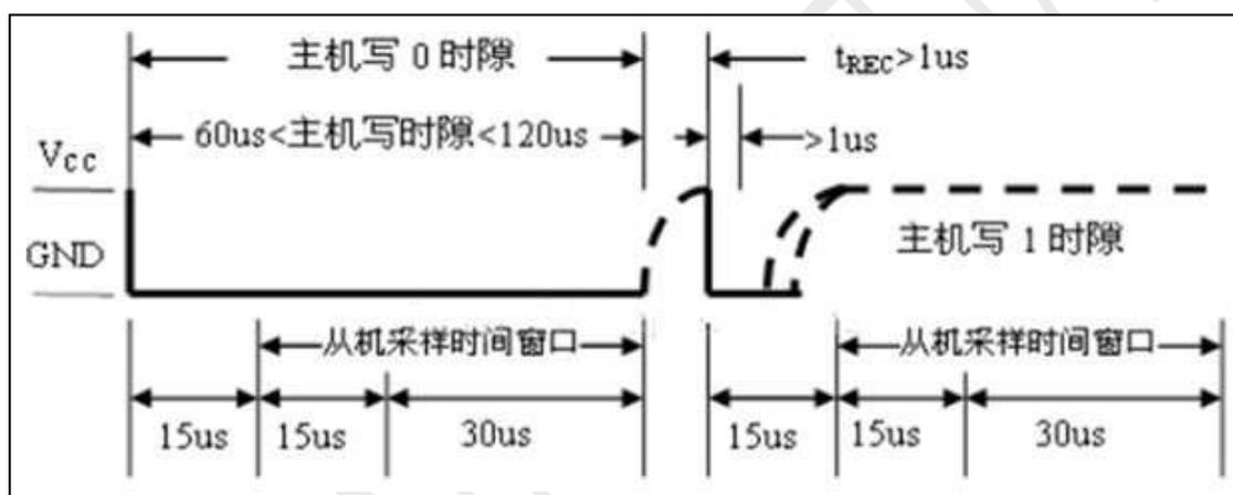
图 25-2 单总线通信协议中写时间间隙时序图
