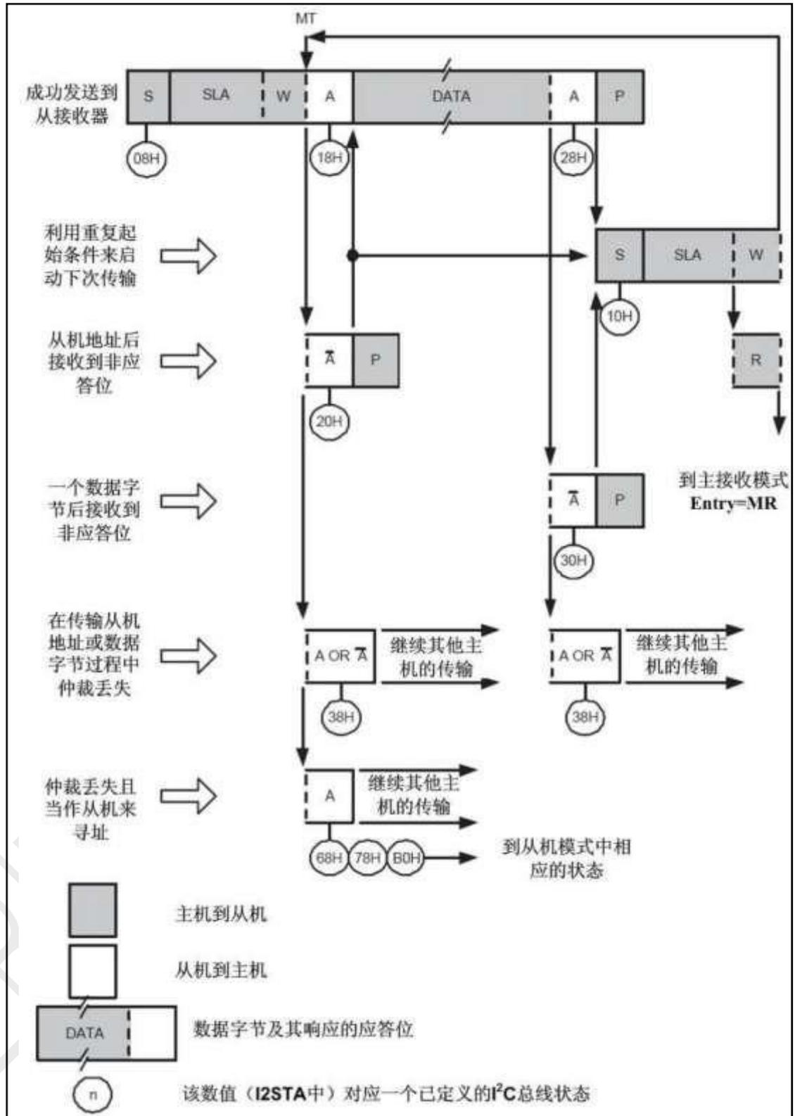
图 23-9 I2C 主机发送状态图
