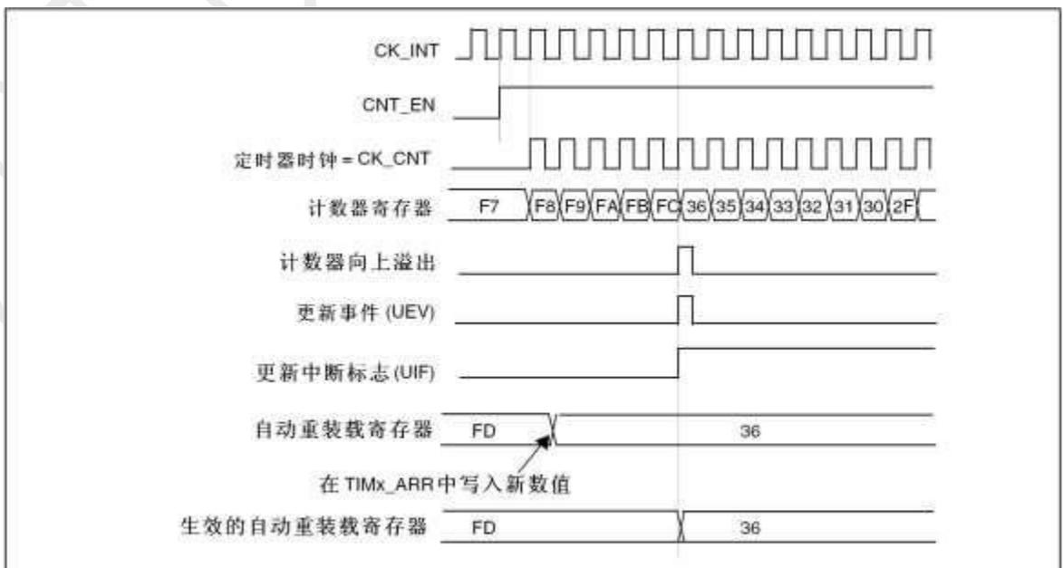
图 13-20 计数器时序图：ARPE=1 时的更新事件(计数器溢出)
