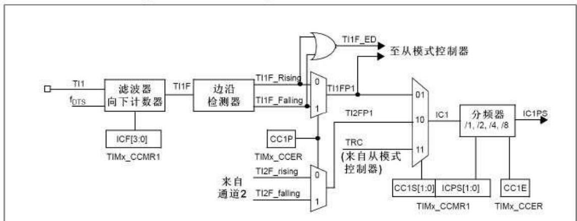
图 13-26 捕获/比较通道(如: 通道 1 输入部分)
