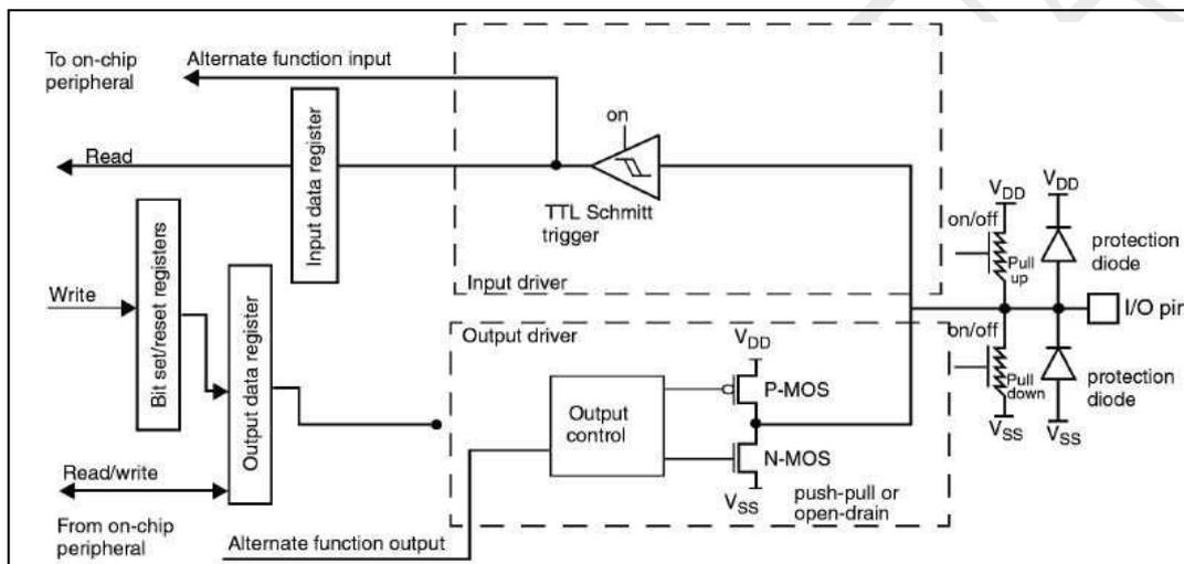
图 9-4 给出了 I/O 端口位的复用功能配置。
