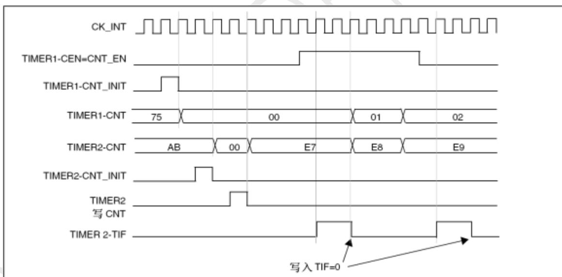
图 13-43 通过使能定时器 1 可以控制定时器 2
