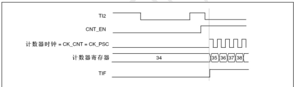
图 13-39 触发器模式下的控制电路
