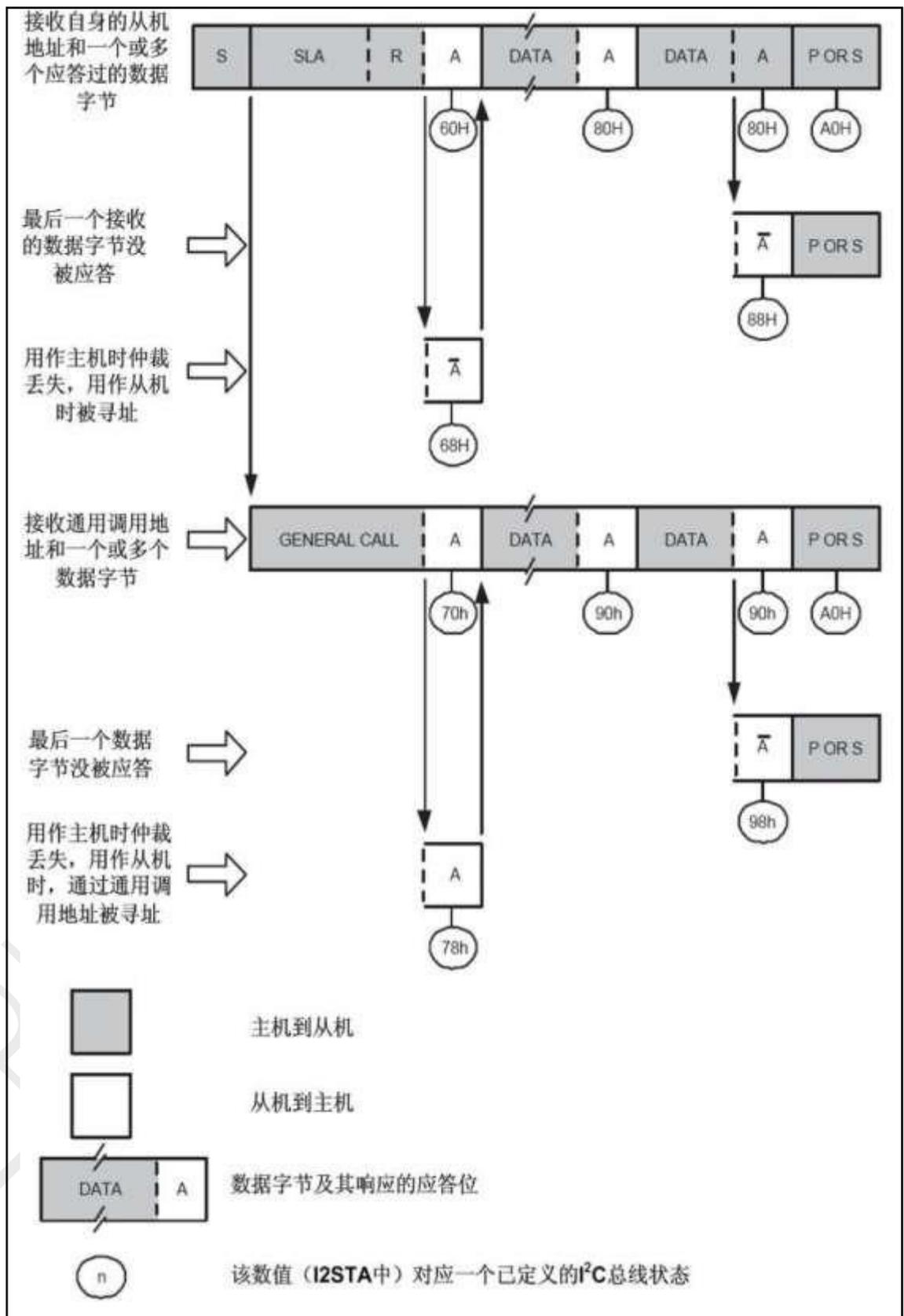
图 23-10 I2C 主机接收状态图
