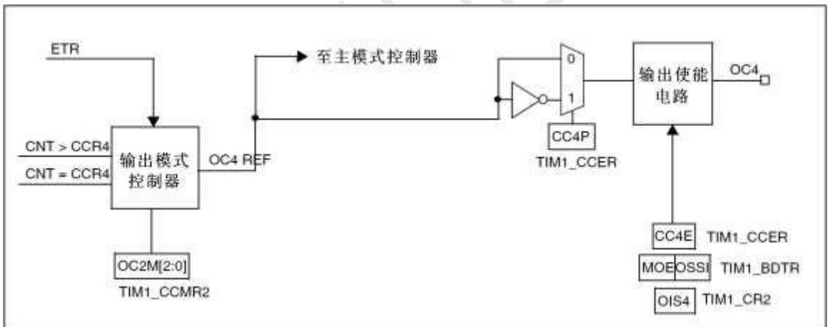
图 12-30 捕获/比较通道的输出部分(通道 4)
