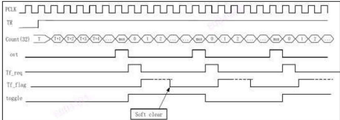
图 15-4 32 位模式 1 时序图(max=0xFFFF FFFF)
