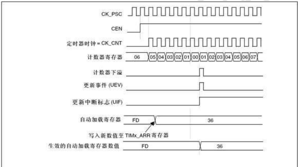
图 12-19 计数器时序图：ARPE=1 时的更新事件(计数器下溢)
