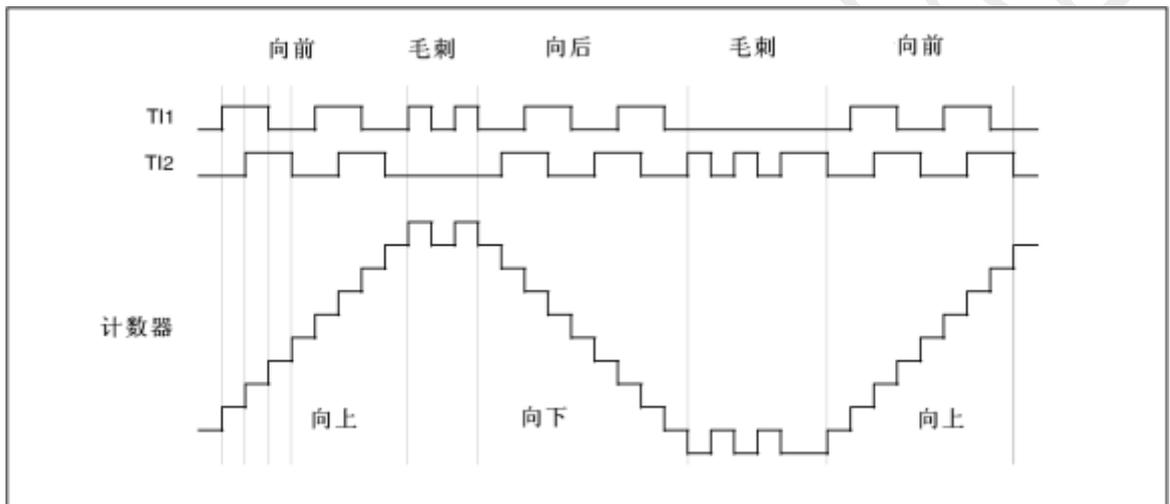
图 12-42 编码器模式下的计数器操作实例
