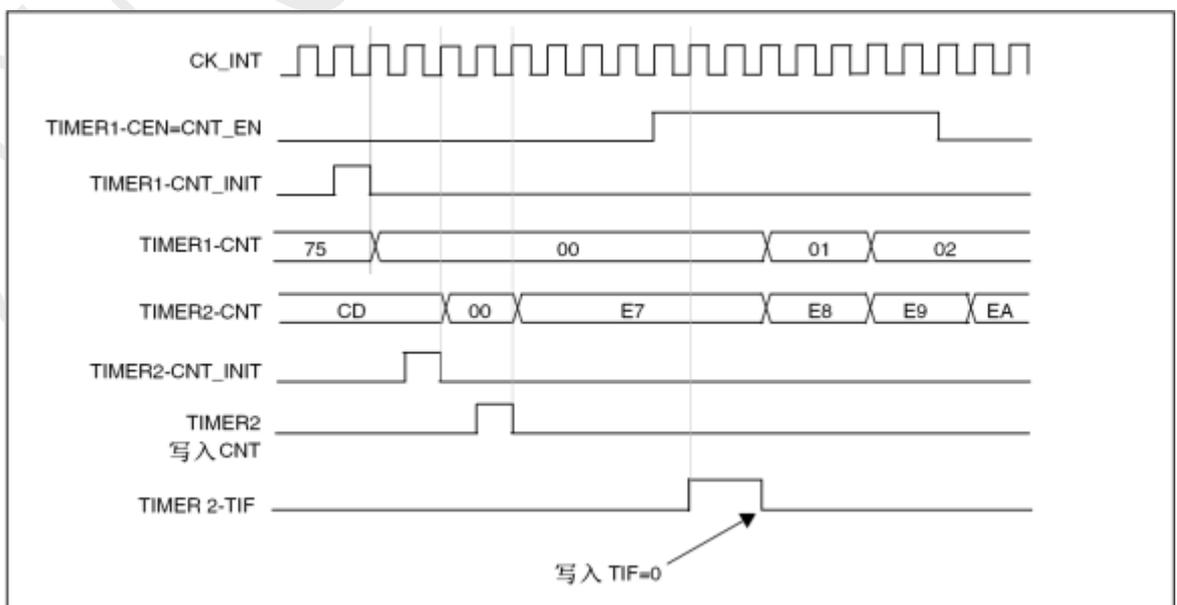
图 13-45 利用定时器 1 的使能触发定时器 2
