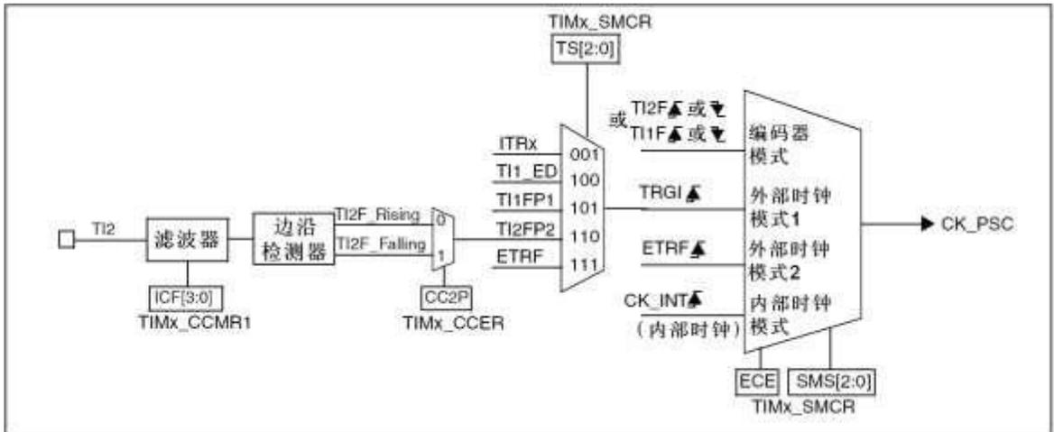
图 13-22 TI2 外部时钟连接例子
