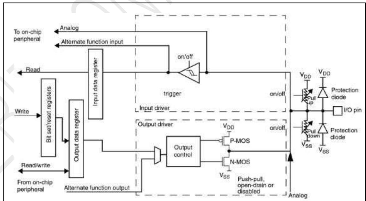
图 9-1 标准 I/O 端口的位基本结构
