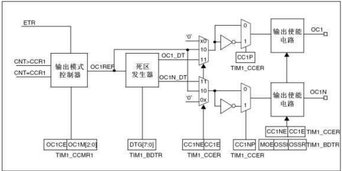
图 12-29 捕获/比较通道的输出部分(通道 1 至 3)
