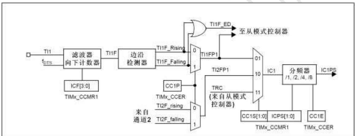
图 12-27 捕获/比较通道(如: 通道 1 输入部分)
