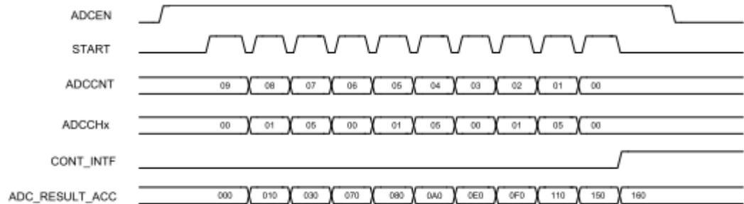
图 28-4 ADC 连续转换累加过程示例
