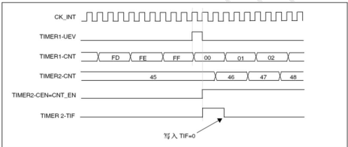
图 13-44 使用定时器 1 的更新触发定时器 2
