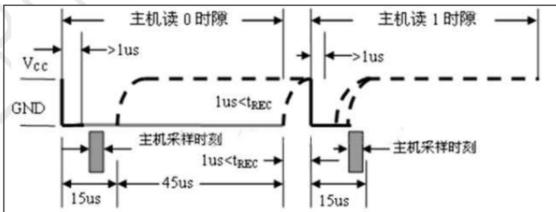
图 25-3 单总线通信协议中读时间间隙时序图
