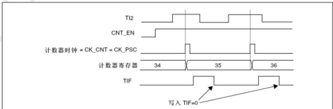
图 12-24 外部时钟模式 1 下的控制电路
