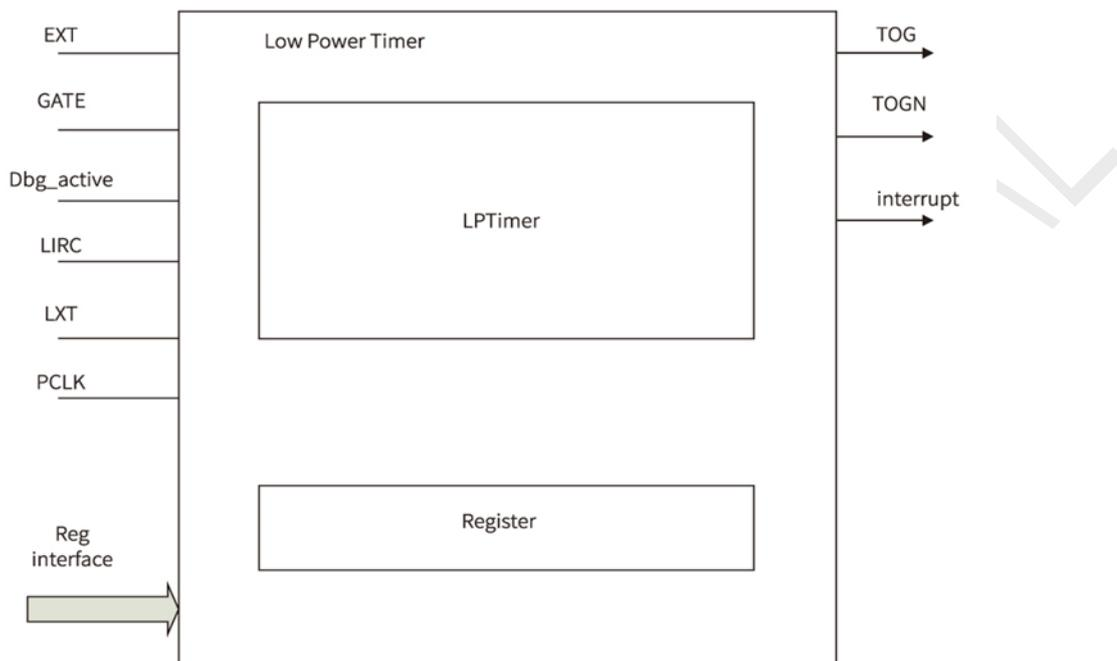
图 16-1 LPTIMER 结构框图
