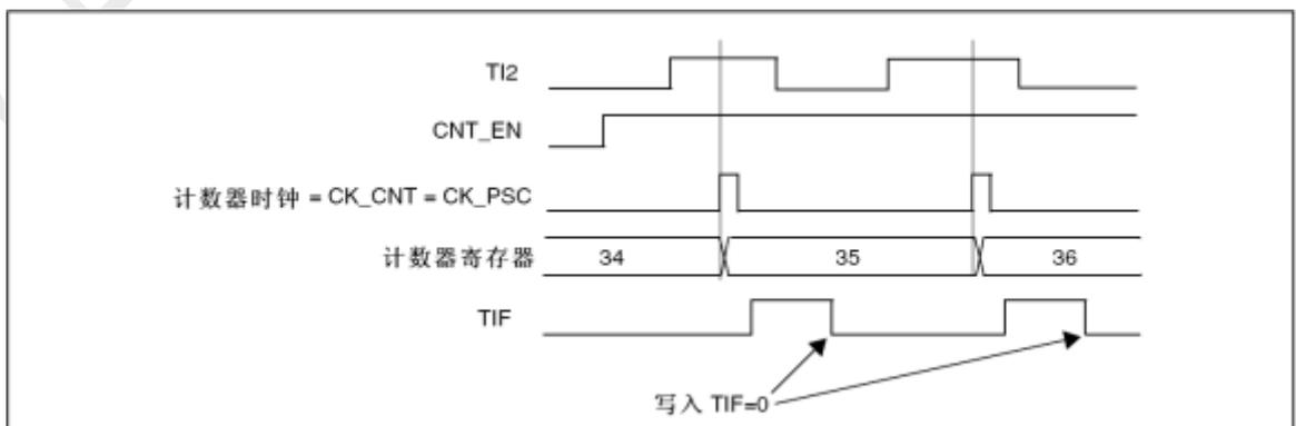
图 13-23 外部时钟模式 1 下的控制电路
