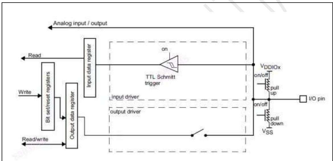
图 9-2 浮空输入/上拉/下拉配置
