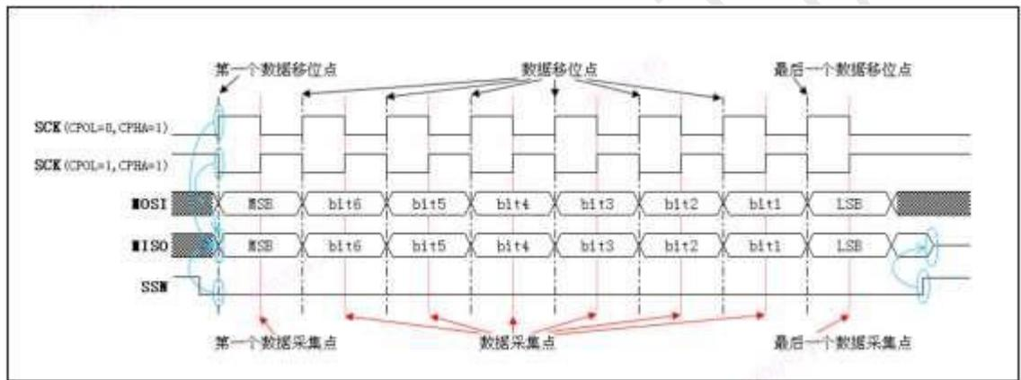
图 24-3 从机方式数据/时钟时序图(CPHA=1)
