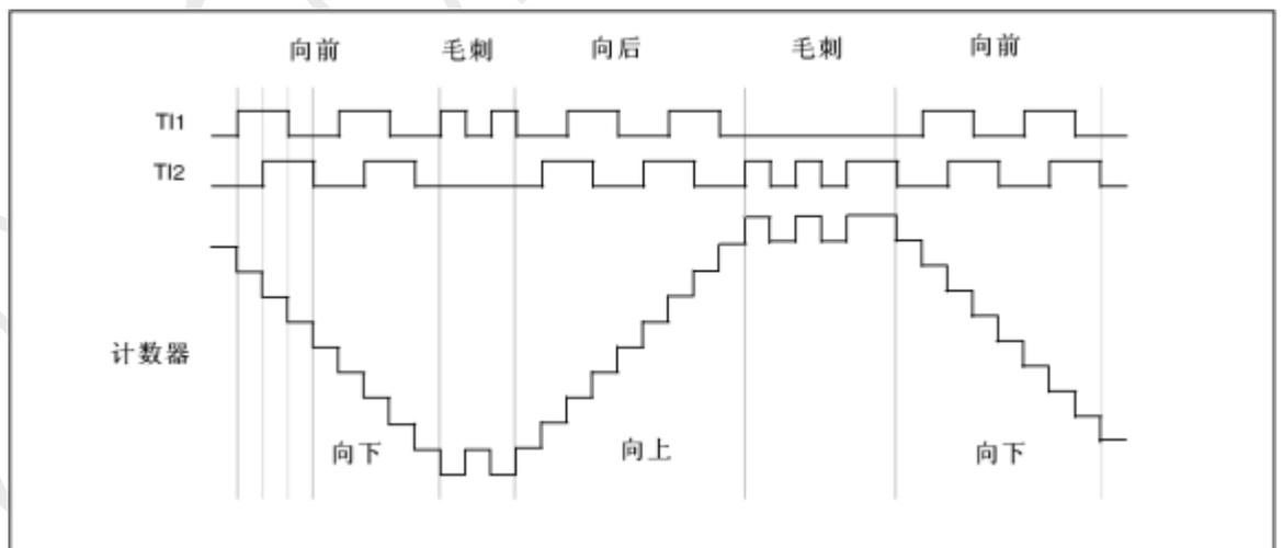
图 12-43 IC1FP1 反相的编码器接口模式实例
