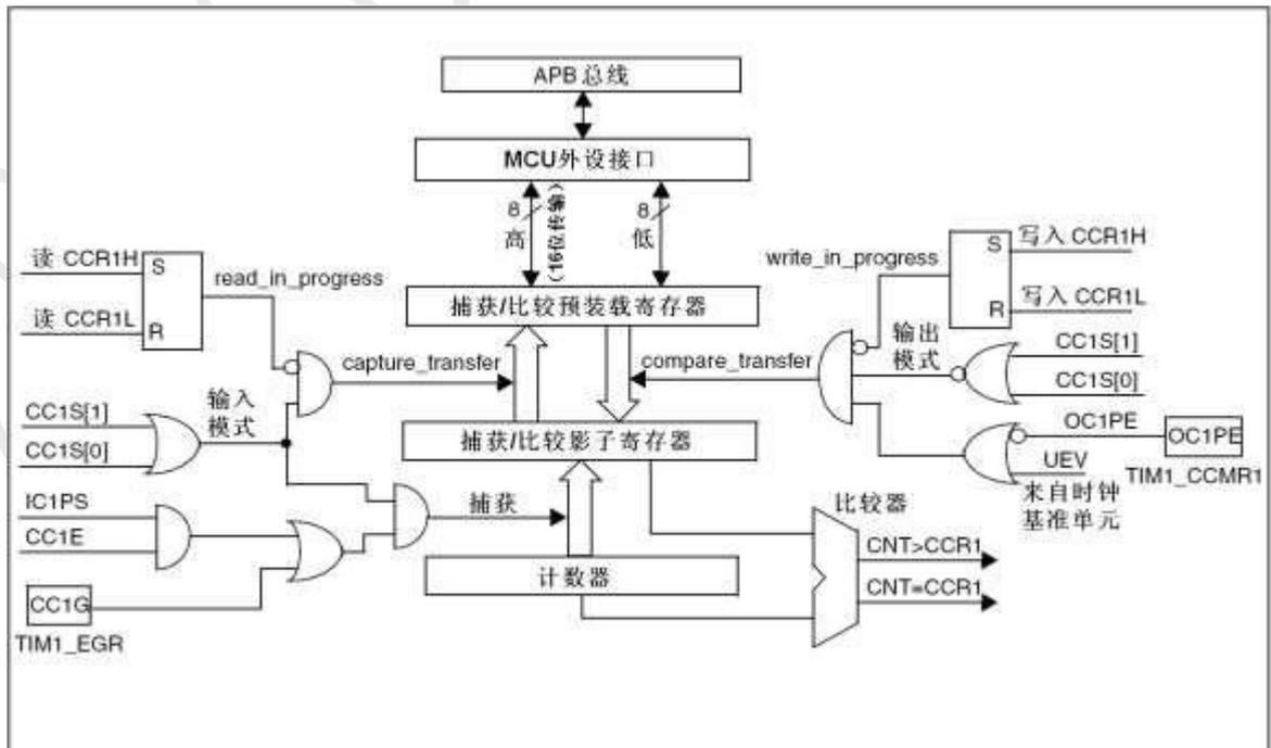
图 13-27 捕获/比较通道 1 的主电路
