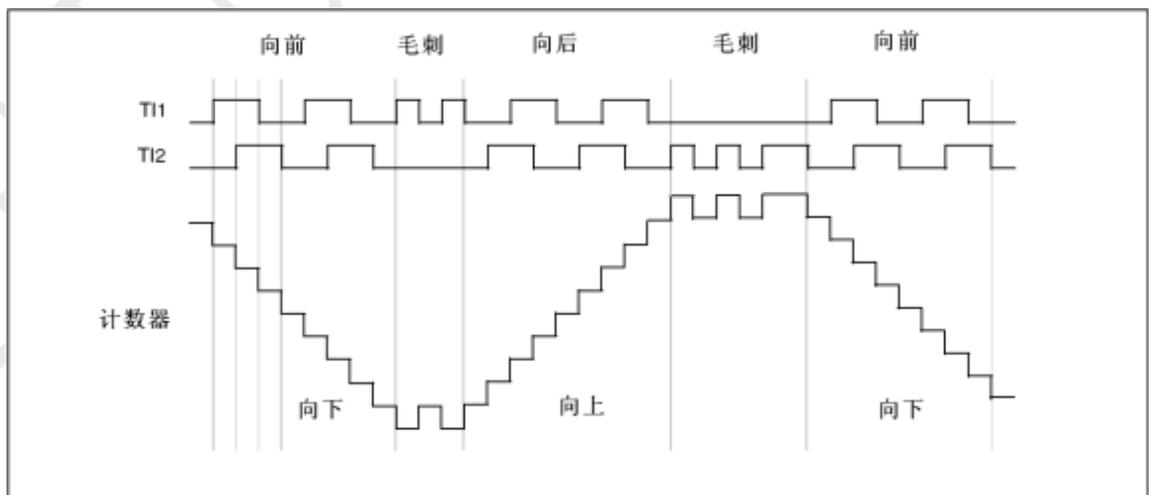
图 13-36 IC1FP1 反相的编码器接口模式实例
