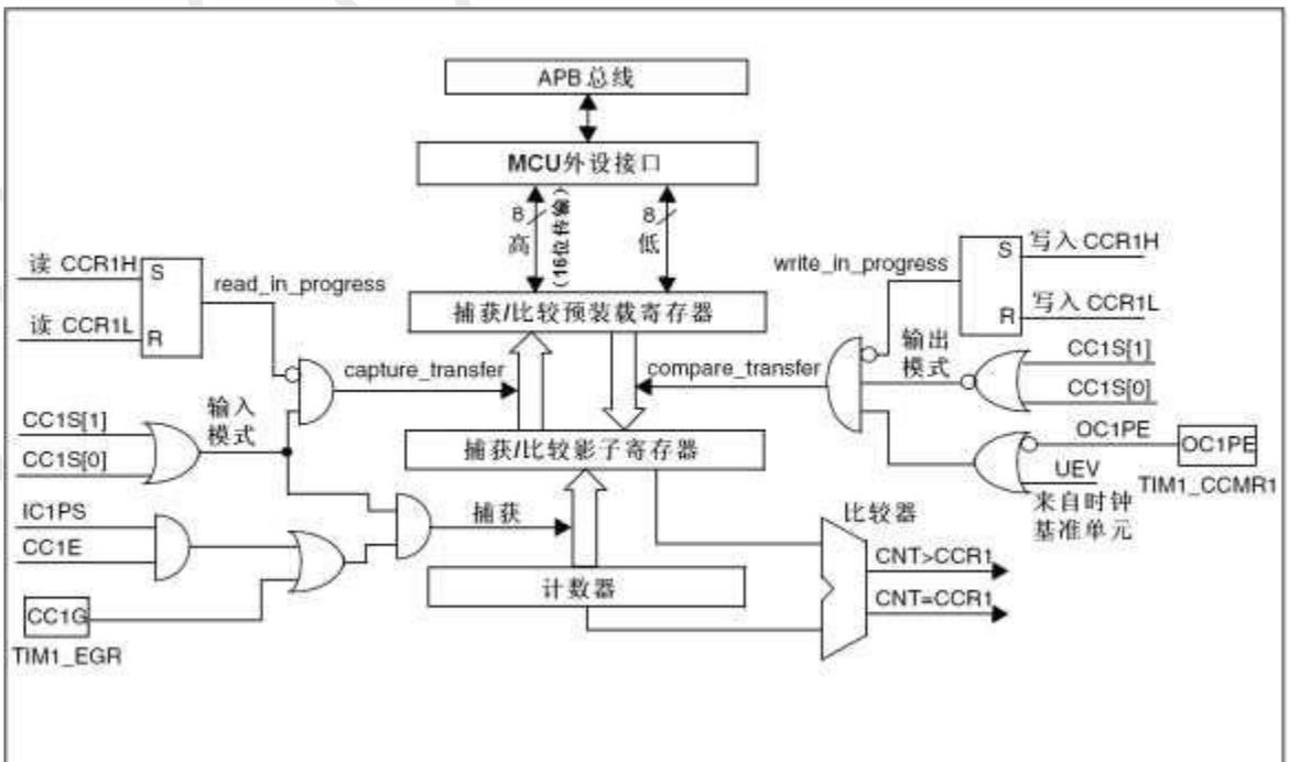
图 12-28 捕获/比较通道 1 的主电路
