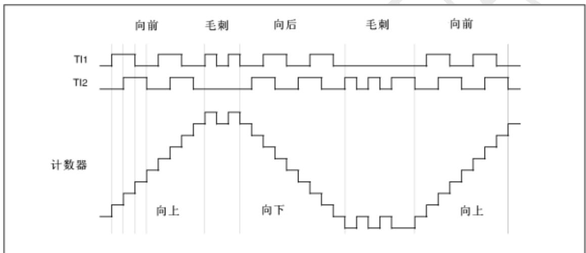
图 13-35 编码器模式下的计数器操作实例
