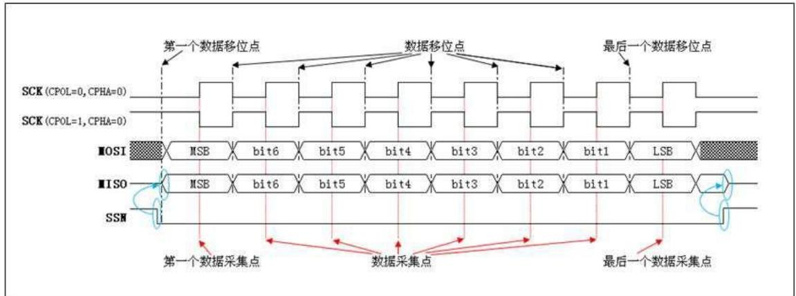
图 24-2 从机方式数据/时钟时序图(CPHA=0)
