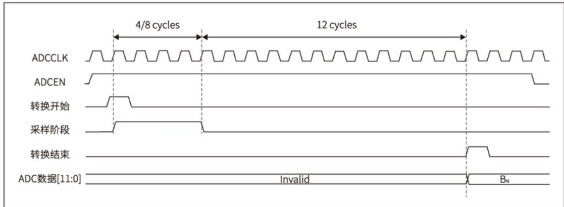
图 28-2 ADC 转换时序图
