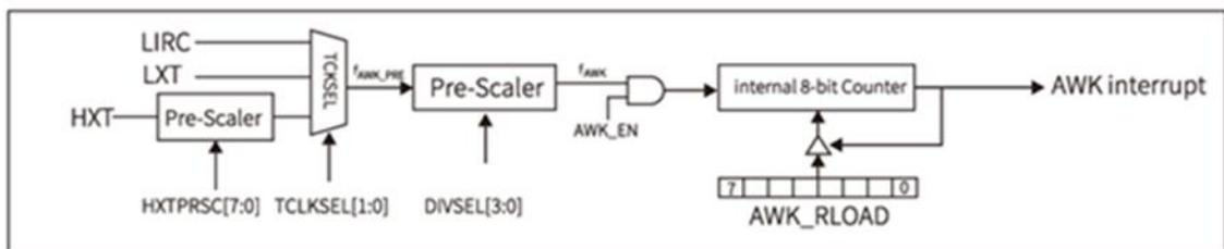
图 17-1 自唤醒定时器结构图
