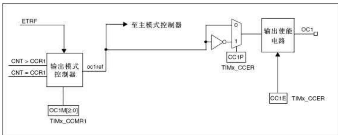
图 13-28 捕获/比较通道的输出部分(通道1)
