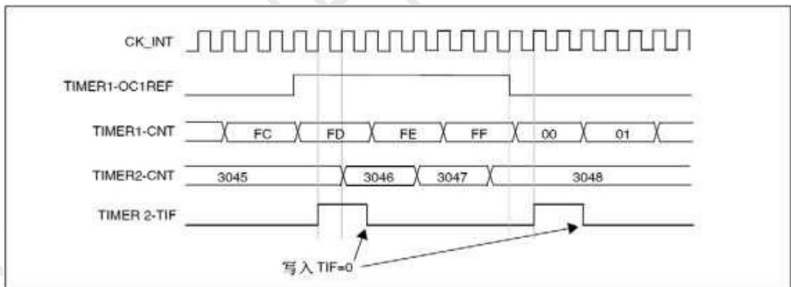
图 13-42 定时器 1 的 OC1REF 控制定时器 2
