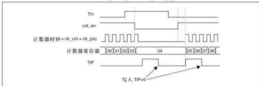
图 12-46 门控模式下的控制电路
