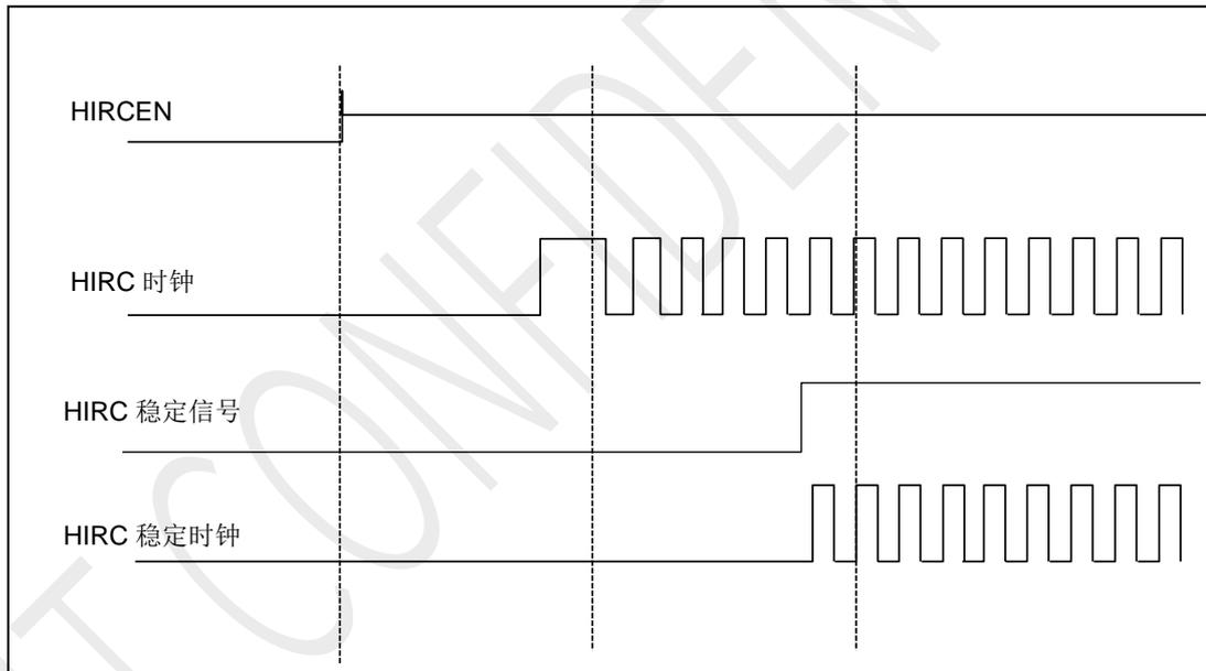
图 6-4 内部高速时钟启动示意图
