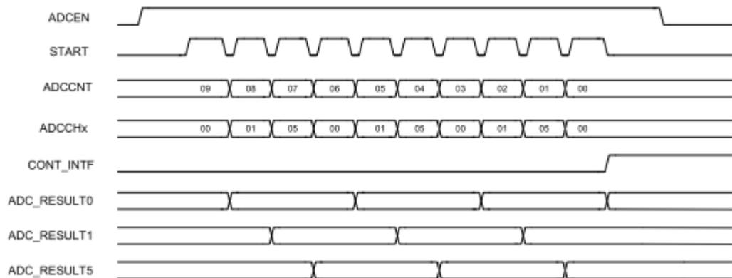
图 28-3 ADC 连续转换过程示例
