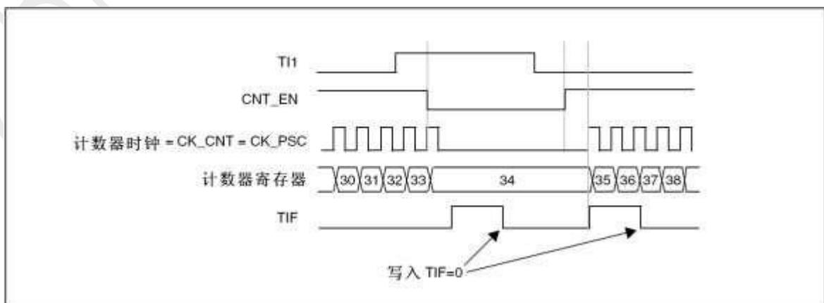
图 13-38 门控模式下的控制电路
