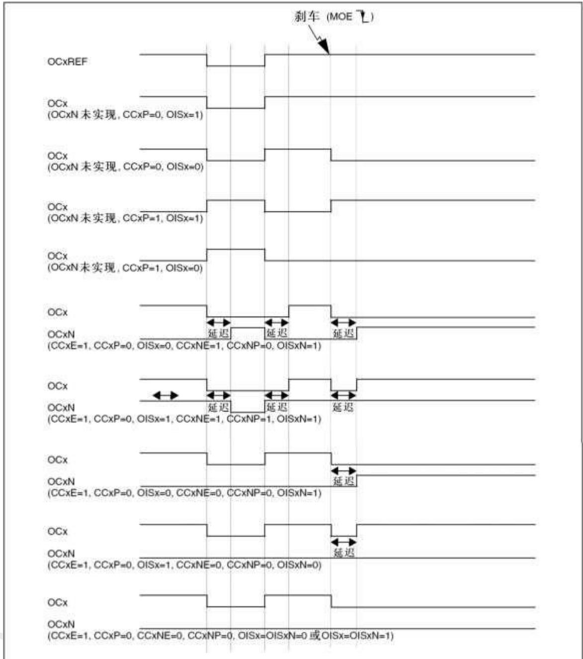
图 12-38 响应刹车的输出
